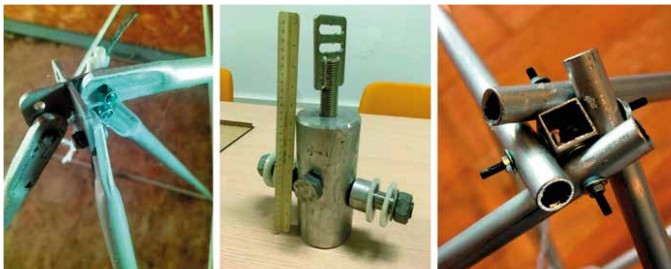
Figura 6. Tipos de nudos: Nudo de aletas, nudo de Escrig, nudo recíproco.
