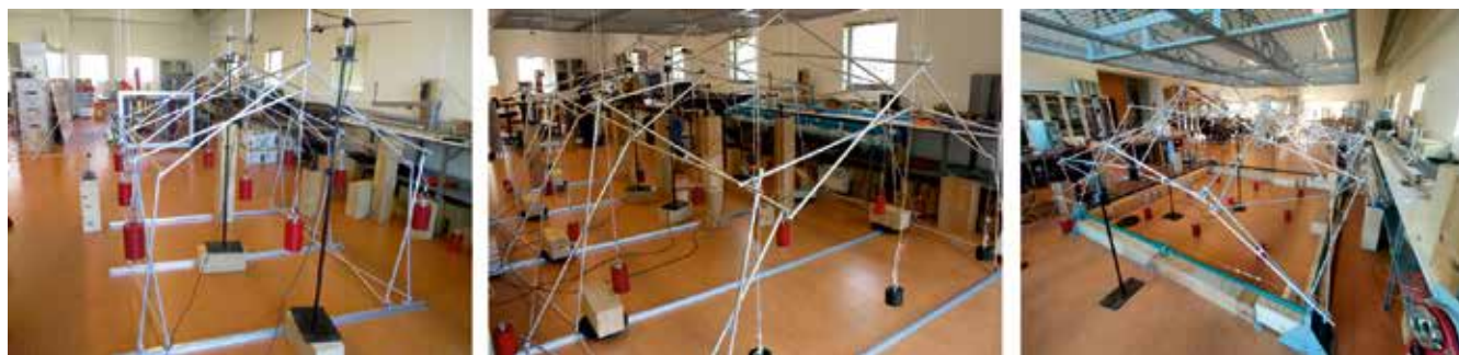
Figura 13. Algunos de los modelos ensayados: cubierta a dos aguas, bóveda con embocaduras cónicas, cúpula.
