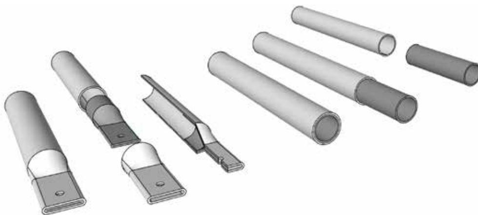
Figura 13. Mecanización de los extremos de las barras: colocación de un tubo interior (derecha) y situación final tras el proceso de aplastado (izquierda).
