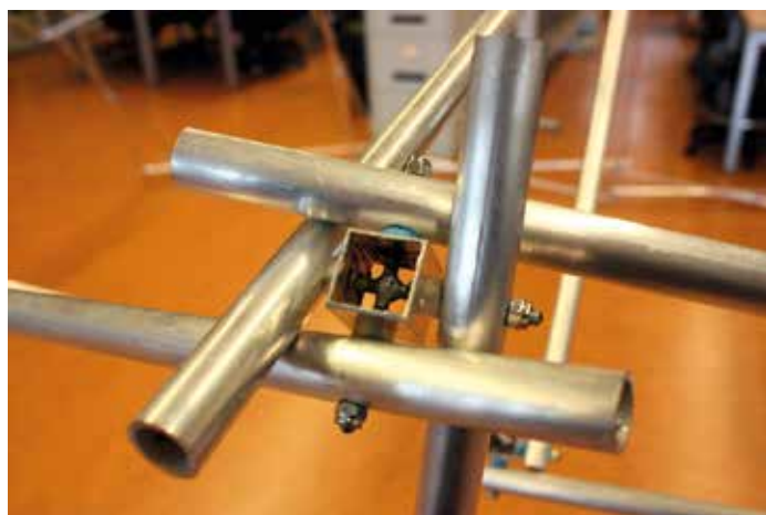
Figura 10. Nudo recíproco sobre prisma cuadrado hueco.
