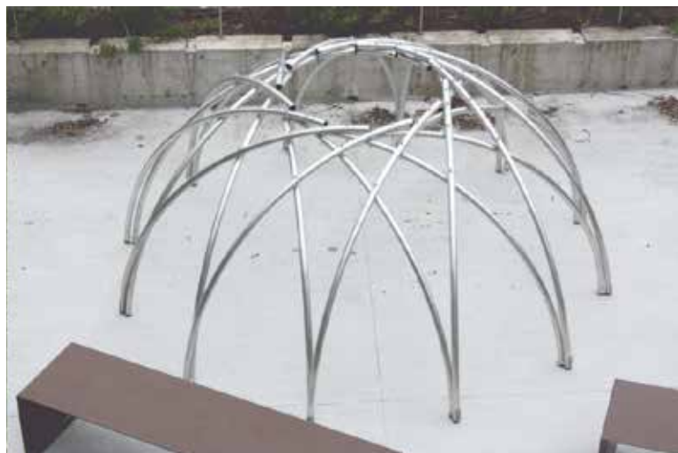
Figura 8. Cúpula desplegable de arcos recíprocos.
